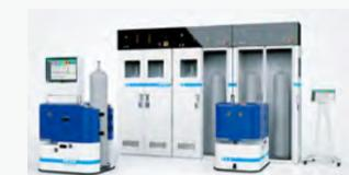
1本50kg以上の重さがあるガス充填容器をロボットが自動搬送します。
