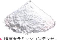
▲ 積層セラミックコンデンサー用チタン酸バリウム
