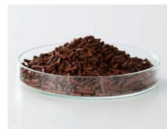
CO<sub>2</sub>固体回収材（成形体）
