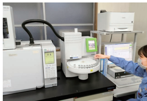
GC/MSによる揮発性有機化合物の分析
