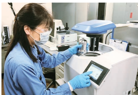
自動熱量計による化学品分析
