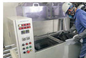
テクノダイナミクス充填ポンプの超音波洗浄機
