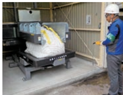
フレコン解し機による固結フレコンの解砕
