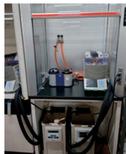
引火点測定機器による危険物判定 (セタ式とタグ式)
