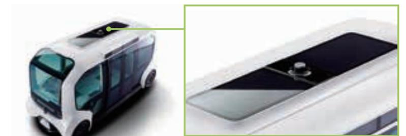
(写真2) トヨタ自動車株式会社の低速自動運転EV「e-Palette」のルーフガラス部分に当社太陽電池が採用
