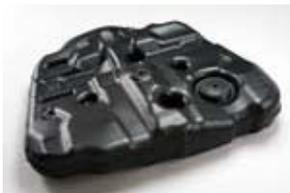
アドマー®は、様々な機能性材料を接着し、多層化によるソリューションを提供できるのが特長。ガスバリア性樹脂にも強力に接着できることから、自動車の樹脂製多層燃料タンクの接着層に採用されています。従来金属製であった燃料タンクを樹脂で代替することで、10～30%の軽量化を実現しています。
