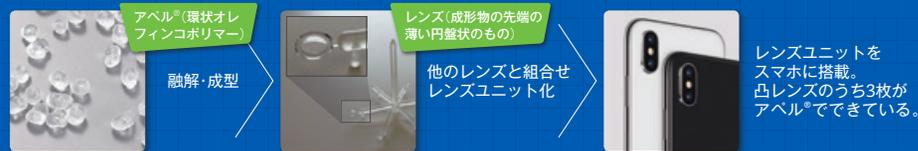
アペル®は高性能な凸レンズの材料として世界で半分以上のシェアを占めています。スマートフォンカメラのレンズは普通のカメラと異なり、小さく軽くする必要がありますが、アペル®を使用すると、口径が小さくても十分な光を取り込むことができ、薄くても近い所に焦点を結ぶことができる透明で屈折率の高いレンズを作ることができます。更に、複屈折が小さいという性質により、像がにじむことなくきれいな写真を撮ることができます。
