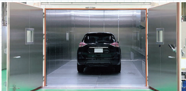
設備の一部である「恒温恒湿槽」(車両状態での評価が可能)
