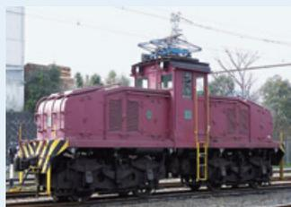
現在も原料・製品の輸送で使用している旧三池炭鉱専用鉄道の電気機関車。
