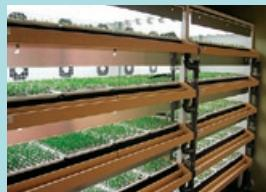
人工光・閉鎖型苗生産装置
