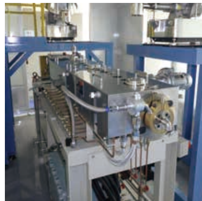
高粘度流体の混合や除熱に優れる二軸押出機
