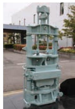
セルロイド製造試験機(圧搾機)
