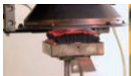
FMプレートの燃焼試験
