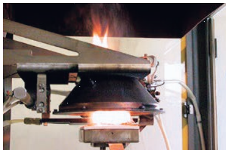
一般PVCプレートは35秒後に着火、燃焼する
