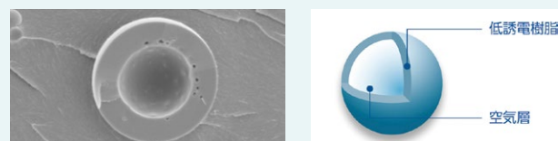
ポリイミド中空微粒子の電子顕微鏡写真(断面)
