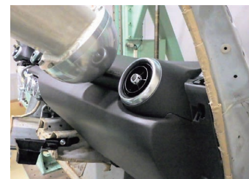
インストルメントパネル衝撃試験
