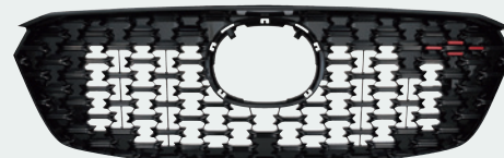
バイオエンジニアリングプラスチックを用いたフロントグリル
