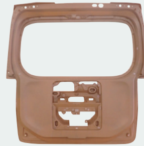
ポリプロピレンにCNFを30%添加したテールゲート・インナーパネル
