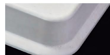
発泡ガスが表面に作る流紋と、環境材が持つ独自の外観を組み合わせることで、製品へ新たな意匠性を与える工法を確立。
