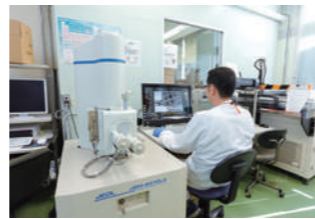
分析機器による外観観察・構成元素の定量
