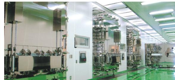
凍結乾燥機および自動搬出入装置
