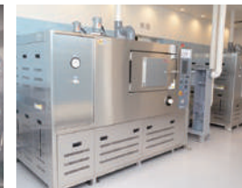
促進防錆試験室
