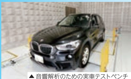
▲ 音響解析のための実車テストベンチ
