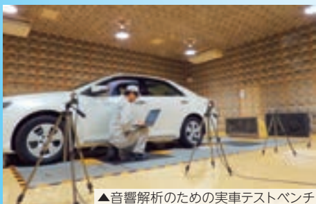
▲音響解析のための実車テストベンチ
