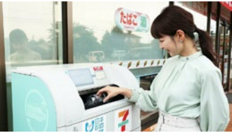
2Lまでのペットボトルを投入すると その場でペットボトルを圧縮
