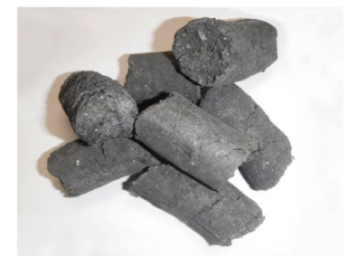
(株)アビツにて特許を取得した製鋼用副資材(商品名:サーモリアクター)
