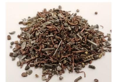
自動車シュレッダーダスト(ASR)の最終残渣から回収された金属類。濃縮された貴金属として金、銀、銅、パラジウムが回収される。
