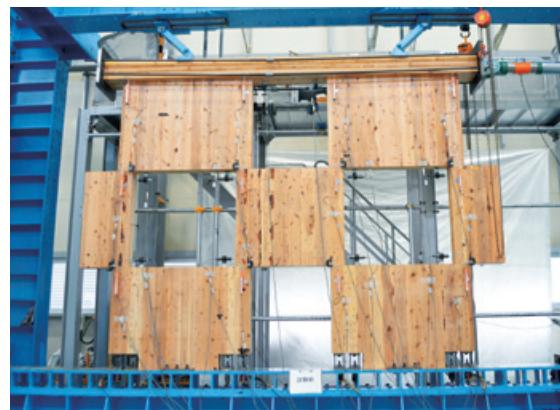
木材パネルを市松状に組み合わせた耐震壁を考案。デザイン性・採光性・施工性の高い建築物の実現が可能に。
