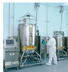
バイオ医薬品製造用の培養槽
