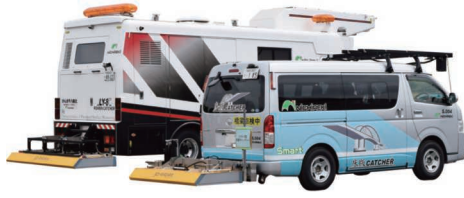
smart床版キャッチャー(橋梁床版非破壊調査車)
