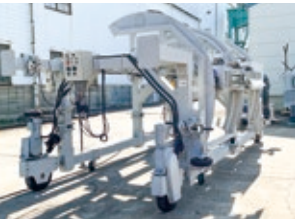
吹付・左官自動施工台車
