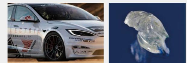
サステナブル素材を採用した「ADVAN A052」を装着し参戦したEV バイオマス由来のブタジエンゴム素材
