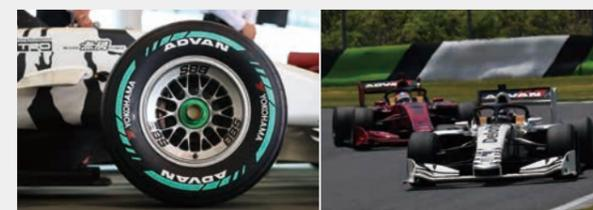
開発中のサステナブル素材の比率を向上したレーシングタイヤ
