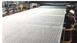
1970年 幅3.2メートルのスチールコード・コンベヤベルトが製造できるドイツ製装置を平塚製造所に導入
