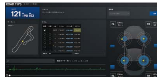
走行結果のタイヤ力を可視化したアプリケーション画面
