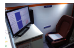
「ドライバーステアリングシステム」(SRセンサ内蔵のクッションをシートに設置)
