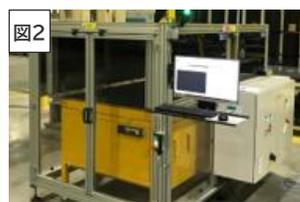
フロントガラス表面に50ミクロン以下の微細な欠陥があると、より複雑な機能が求められるガラス製品では性能が制限される可能性がある。しかしながら、従来のオンライン検査システムではそれを検出することができなかった。この課題を解決するための、新しい検査システムの開発に取り組んでいる。
