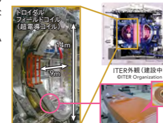
超伝導コイルを絶縁するために、当社の絶縁材料「GKテープ」が使用されています。
