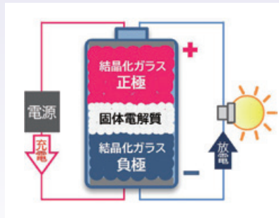
オール酸化物全固体Naイオン二次電池の構造
