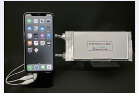
開発した電池によるスマートフォンの動作試験
