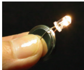
▲ 作製した電池による点灯テスト
