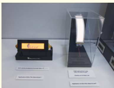
〈G-Leaf®〉を用いたフレキシブルな有機EL照明
