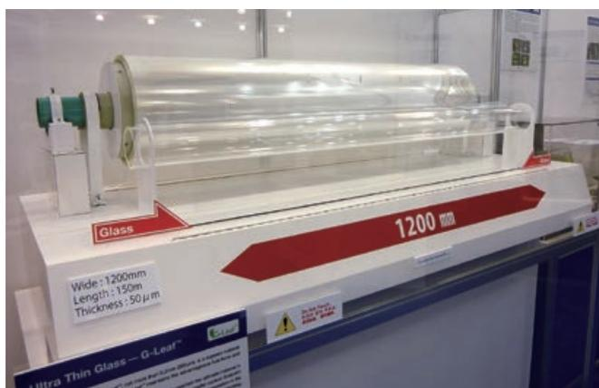
幅1.2m、長さ150m、薄さ50μmの<G-Leaf®>
