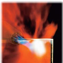
2000℃を超える高純度火炎のバーナー加工により、溶接や成形を繰り返し製品形状を作り上げます。主に半導体基板となるシリコンウェハを熱処理するための保持治具等に使用されています。
