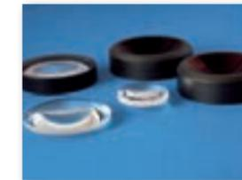
研磨プリフォームを高温に加熱・軟化させ、超高精度非球面金型で形状を転写させ、芯取加工・コート加工を施したレンズ
