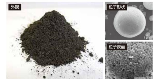
リチウムイオン電池の正極材料「ナリチア」
