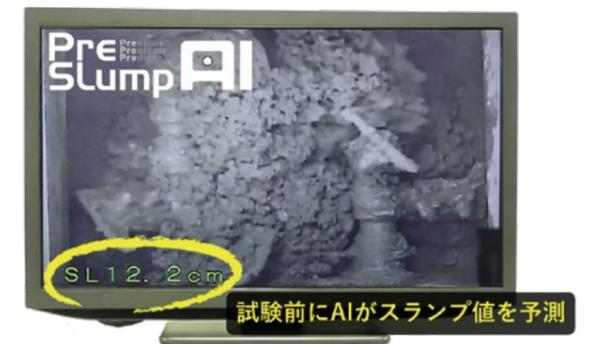
練混ぜ後のコンクリートのスランプ予測システム「PreSlump AI」のモニター画面:AIによる画像認識を利用し、ミキサ内のコンクリート練混ぜ画像から、瞬時に高精度でスランプの予測を行うことができます。2023年4月より、パシフィックシステム社から販売を開始しました。
