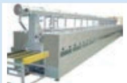
食器の絵付け焼成から始まったノリタケの「乾燥炉・焼成炉」。正確な雰囲気調整と温度管理ができることが特長です。自動車や電子部品など幅広い分野で活躍しています。
