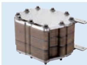
固体酸化物形燃料電池(SOFC)とは、空気中の酸素(O<sub>2</sub>)、都市ガス等を改質して取り出す水素(H<sub>2</sub>)や一酸化炭素(CO)を利用し発電するものです。発電の重要な部分であるセルスタックの構成はすべてセラミックスで構成されています。
