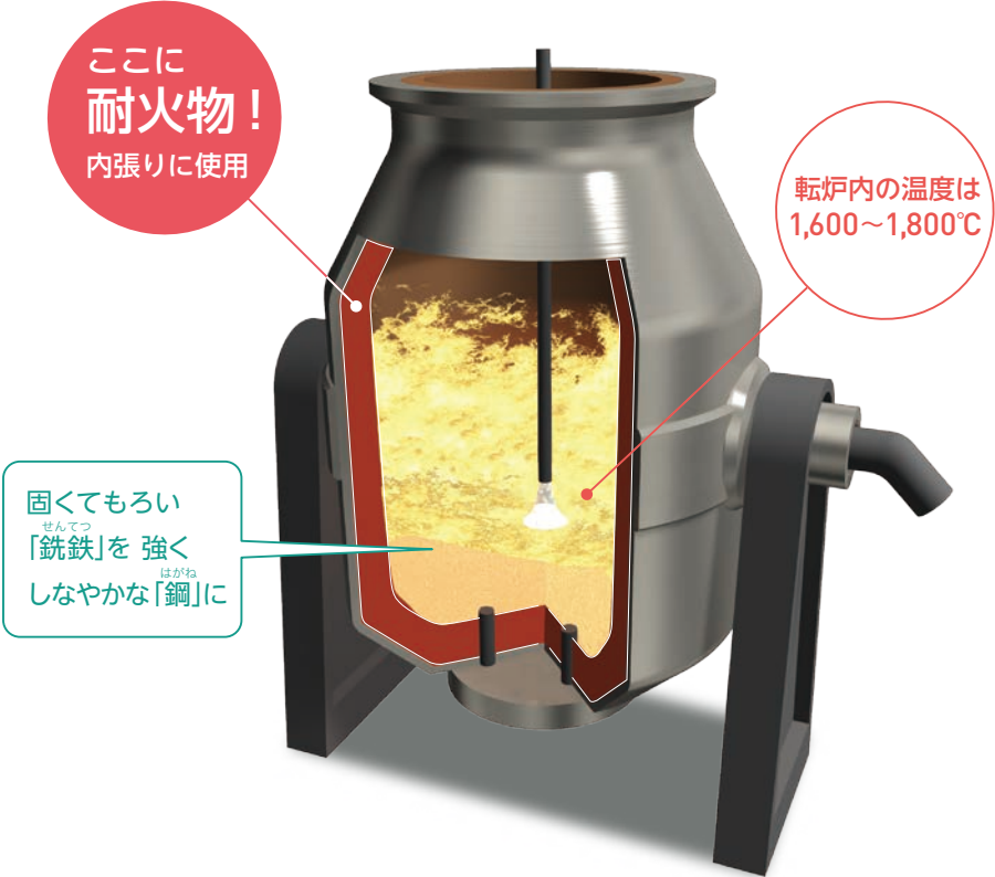
耐火物の使用例（転炉）
