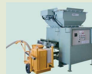
不定形耐火物 施工装置
