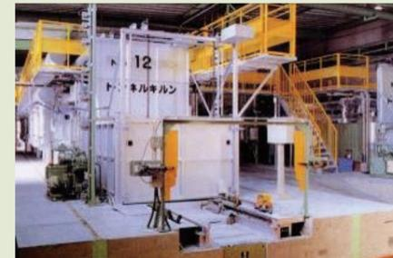
工業炉の製作事例 ② トンネル式焼成炉
