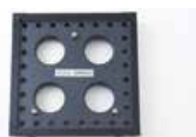
ゼロ膨張セラミックス NEXCERA™の優れた寸法安定性、環境ロバスト性を活かし、原器や精密測定機器の更正器として適用
