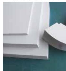
静止空気をしのぐ低熱伝導率を実現する断熱材で、省エネや薄肉化・小型化・軽量化による生産性向上に寄与します。
