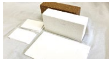
100%水素燃料・1700°Cで焼成した耐火物
