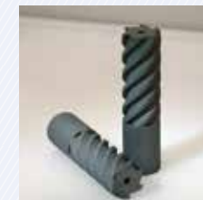
3Dプリンターを用いて製作した超硬工具
